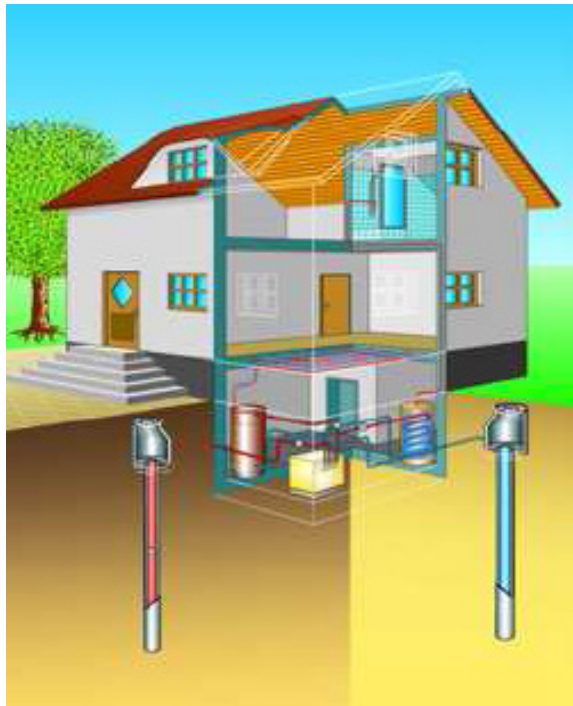
Saug- und Schluckbrunnen (Sole/Wasser-System)
