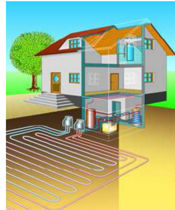
Erdkolektoren in ca. 1 m Tiefe (Sole/Wasser-System)
